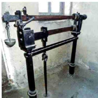
Sous la plateforme, dans une fosse creuse, se trouvait un système de leviers de pesée. Le véhicule passait sur la plateforme à vide puis à plein. Les poids s'affichaient sur un cadran installé l'intérieur du bâtiment ; le responsable délivrait un document officiel, « le bon de pesage » qui ne pouvait être contesté.
